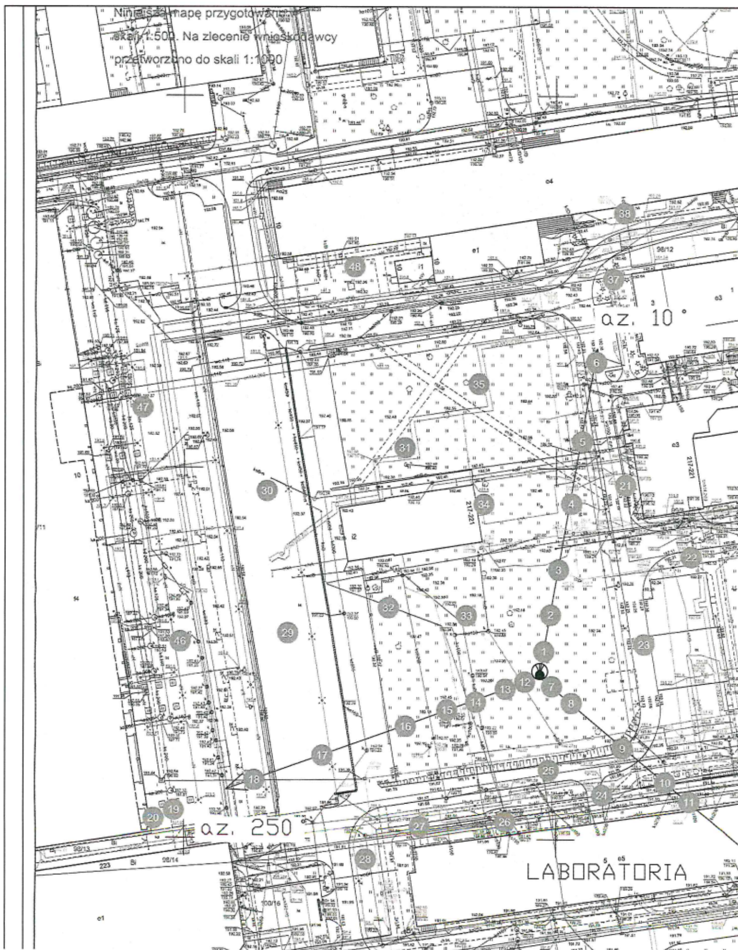
Rys.1 Lokalizacja pionów pomiarowych
