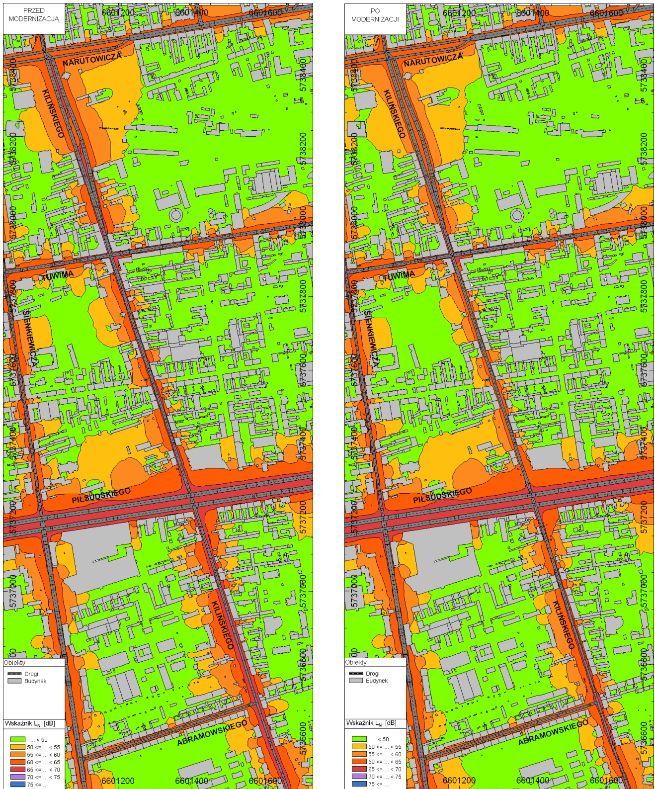
Rys. 13. Efekty modernizacji nawierzchni drogowej. Zasięg hałasu – dla wskaźnika L_N – odcinek ulicy Kilińskiego
