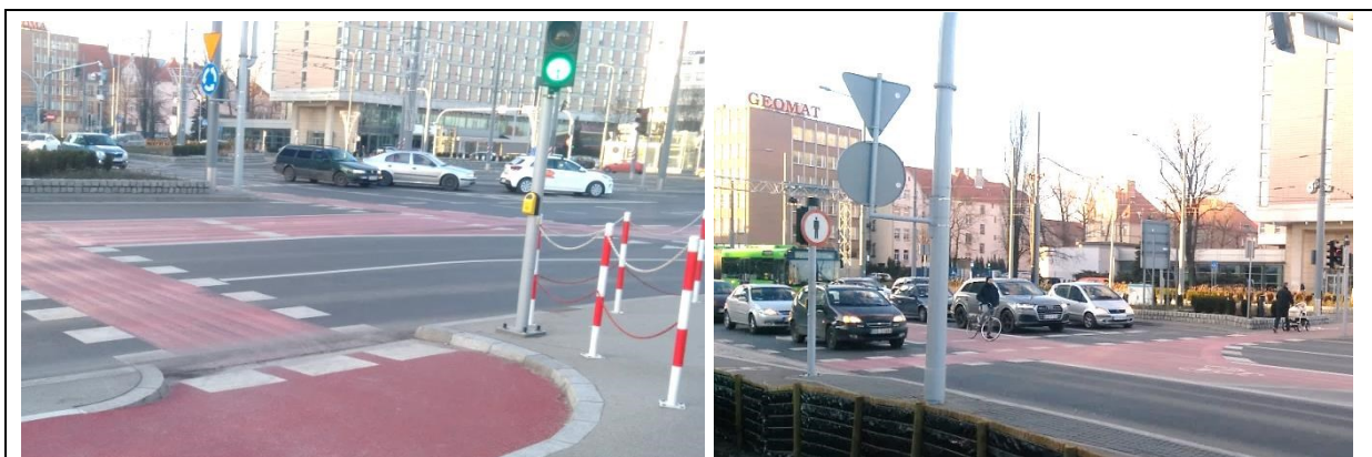
Rys. 20 Włączenie drogi rowerowej w wydzielony pas przeznaczony wyłącznie dla ruchu rowerowego - oznaczenie dróg rowerowych kolorem czerwonym (materiały własne)
