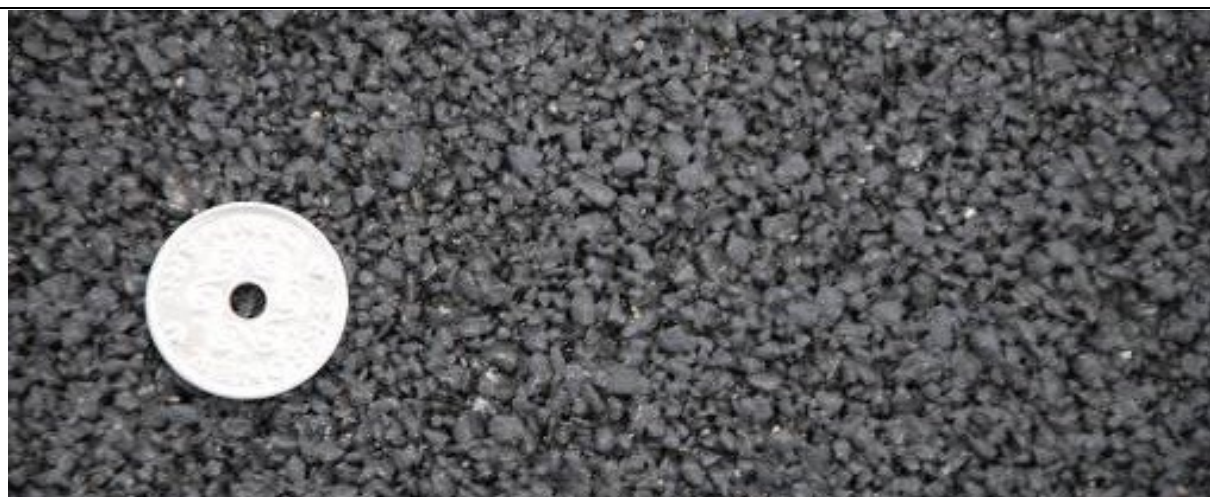
Rys. 27 Struktura nawierzchni jednowarstwowej (źródło: DVS-DRI Super Quiet Traffic International search for pavement providing 10 dB noise reduction , Danish Road Institute Report nr 178, 2009)
