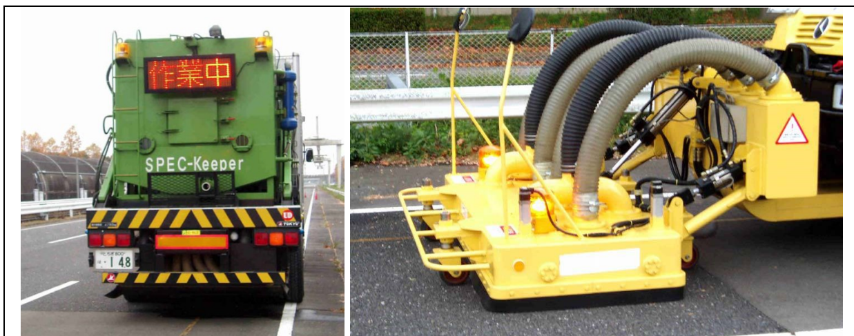
Rys. 65 Po lewej - samochód do czyszczenia cichych nawierzchni; po prawej - czyszczenie nawierzchni przy wykorzystaniu sprężonego powietrza (źródło: Noise reducing pavements in Japan - study tour report, Danish Road Institute, 2005, DRI-DWW noise abatement program)
