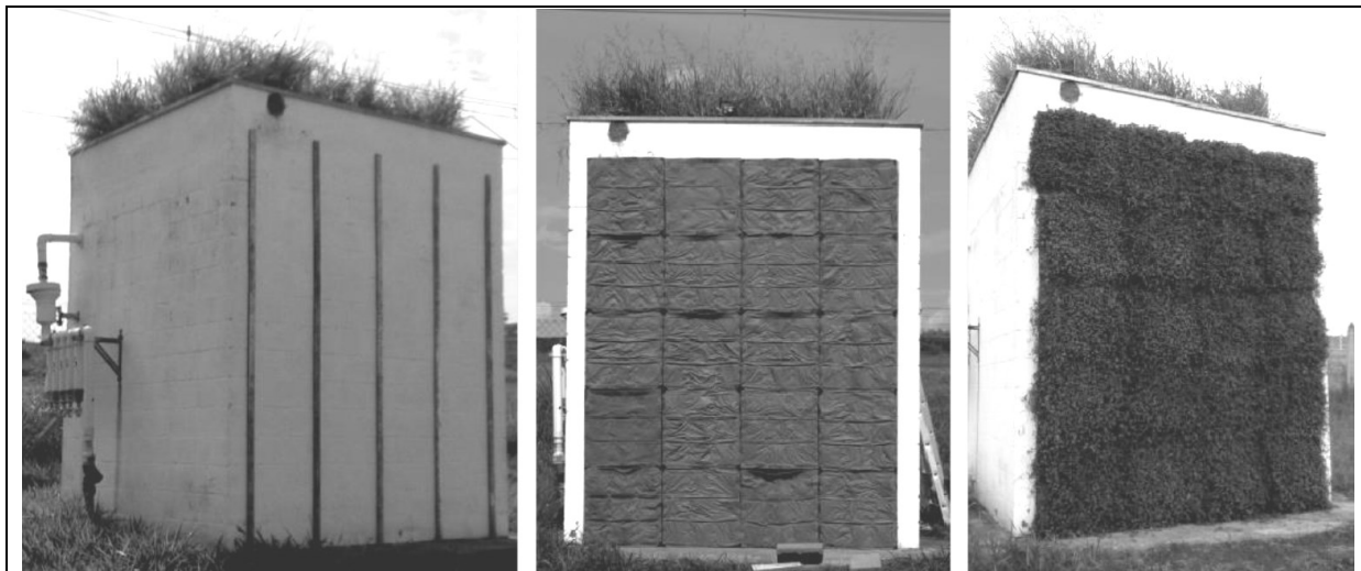
Rys. 49 Zielone ściany (green walls) o wysokim współczynniku pochłaniania jako rozwiązanie redukujące hałas w kanionach ulicznych; od lewej – Konfiguracja I – ściana z zamontowanymi słupami stalowymi, Konfiguracja II – ściana z 20 panelami ze sklejki na stalowych słupach + kieszenie z geowłókniny + podłoże; Konfiguracja III – jak w II + roślinność (źródło: jw.)
