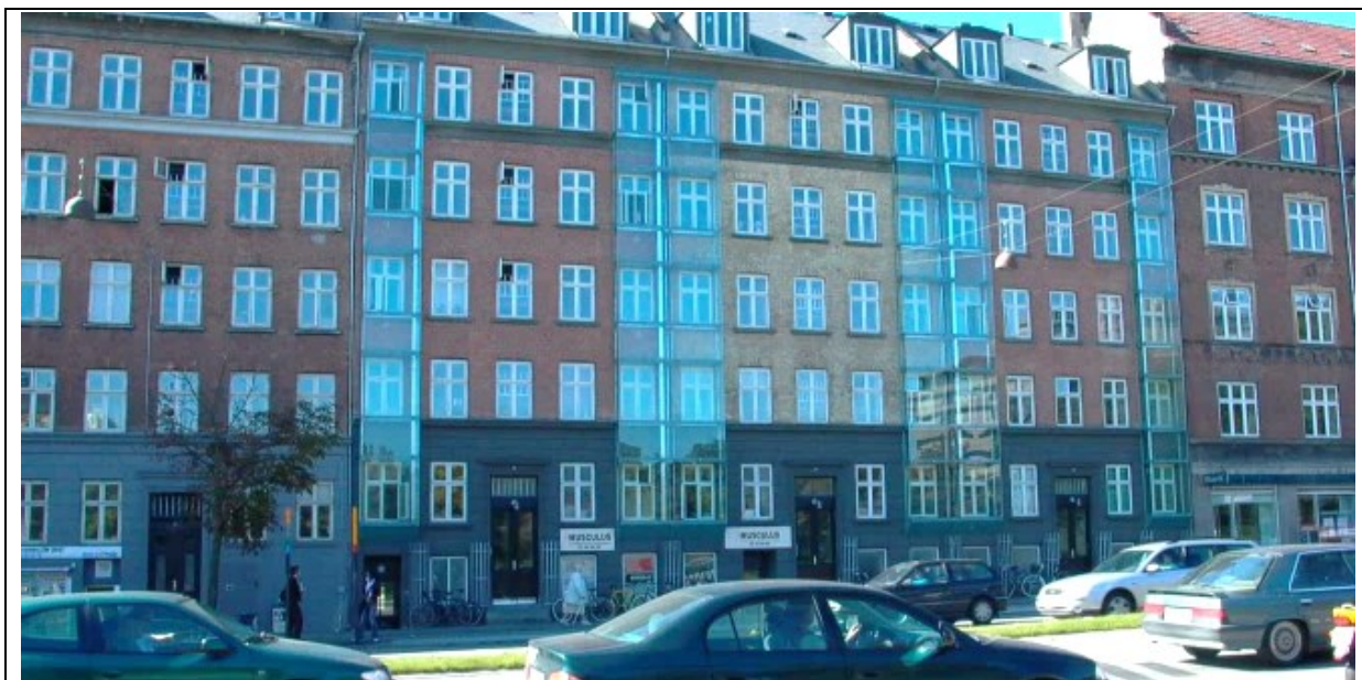
Rys. 52 Elewacje szklane przy fasadach pomieszczeń sypialnianych budynku ulokowanego tuż przy drodze głównej; brak miejsca na budowę ekranu akustycznego (źródło: jw.).
