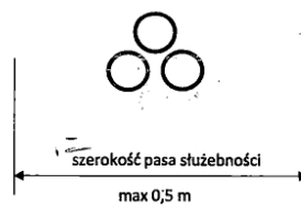
Rysunek nr 4 - Linia kablowa SN jednotorowa
