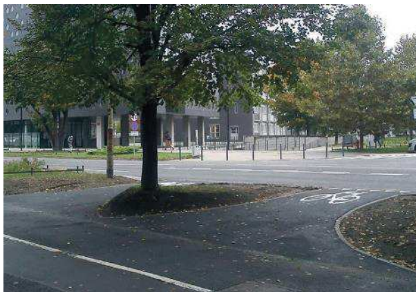
Zdjęcie 27 Czwarty wlot rowerowy na skrzyżowanie typu T - odseparowany wjazd i zjazd. Wrocław, Polska
