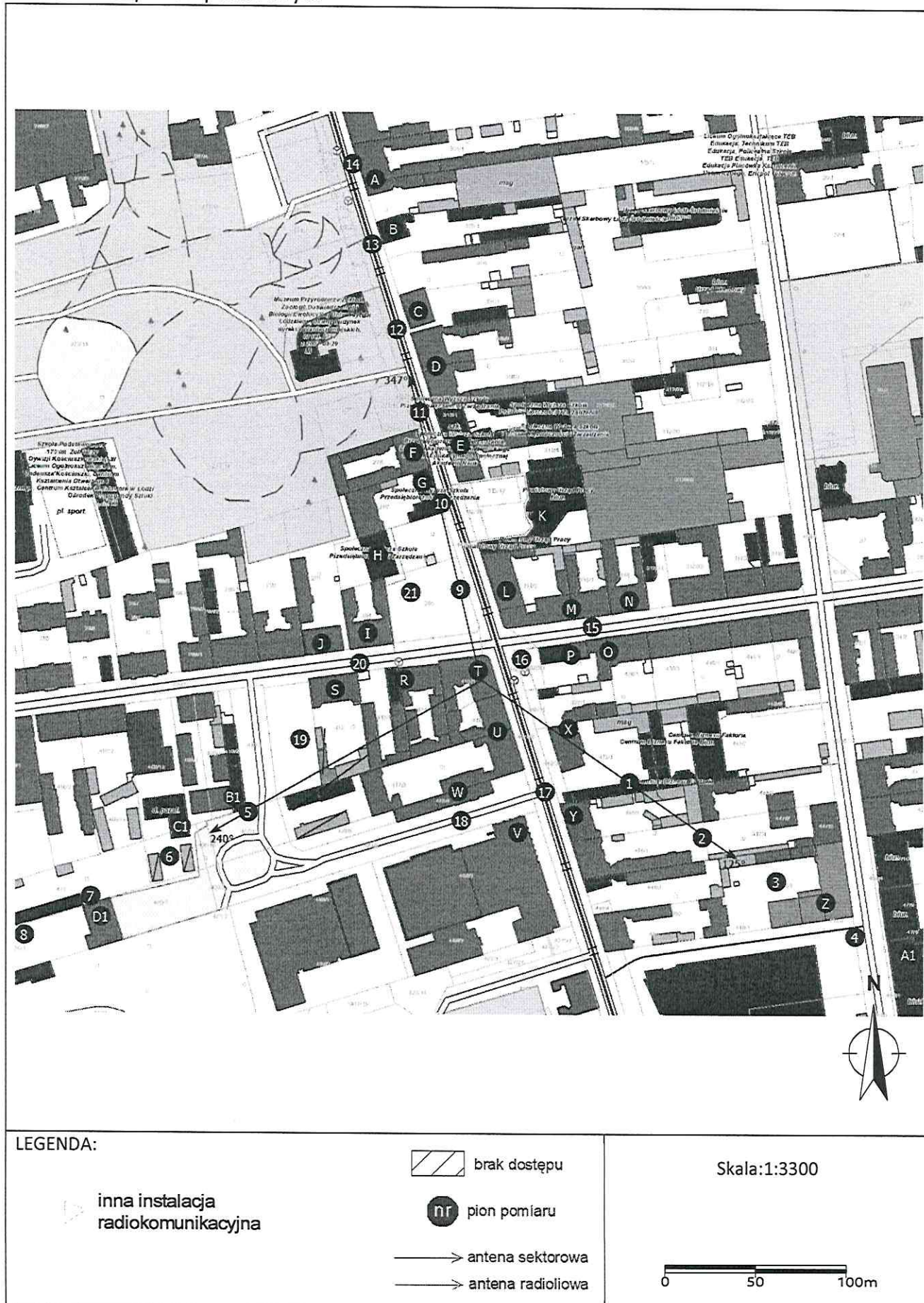
Załącznik 2. Widok pionów pomiarowych
