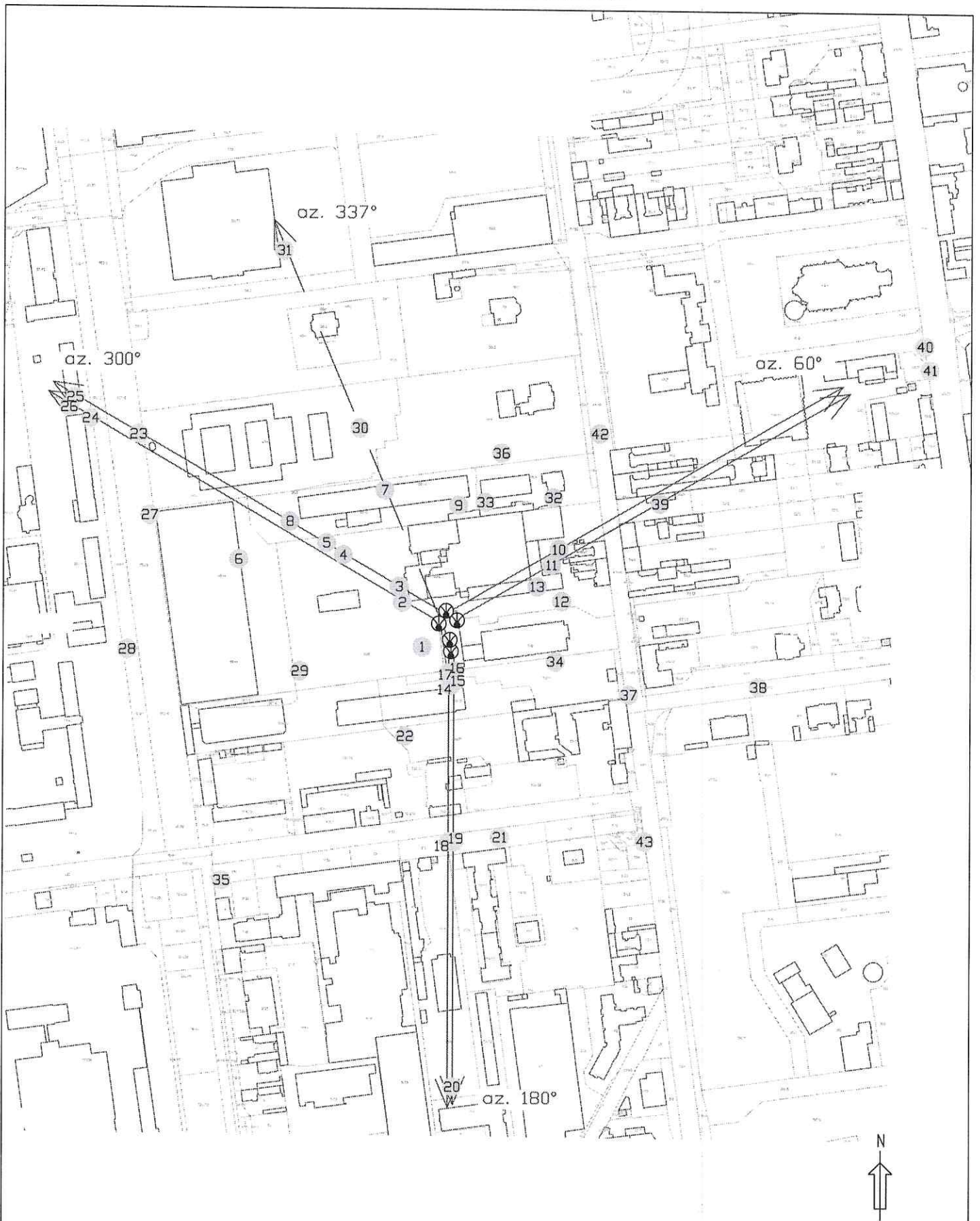
Rys.1 Lokalizacja pionów pomiarowych
